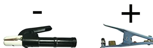
ПОЛОЖЕНИЕ ЭЛЕКТРОДА ПРИ СВАРКЕ
